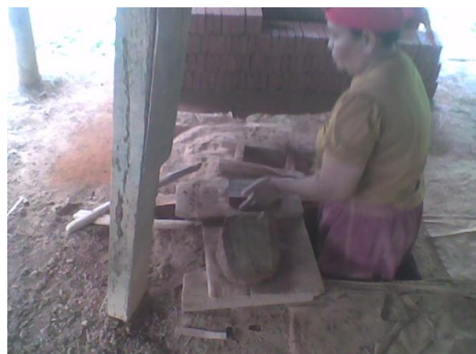
Gambar 14. Pencetakan Bata Dibakar
