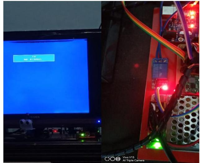
Gambar 7. Kondisi Relay Pada Jarak Aman
