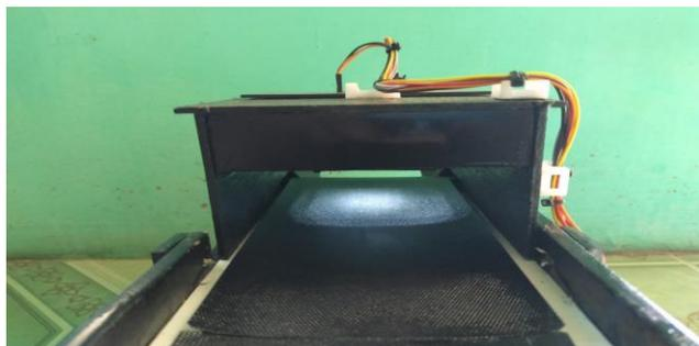
Gambar 7. Tampilan Sensor Warna *TCS230*
