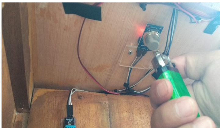
Gambar 11. Mengukur Keluaran Kepekatan Gas menggunakan Sensor MQ-9
