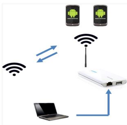
Gambar 3. Skema Diagram Sistem Komunikasi VoIP
