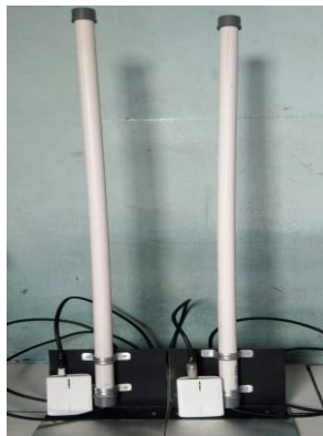
Gambar 16. Tampilan antena omnidirectional dihubungkan dengan Tp-Link MR-3040
