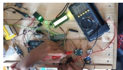
Gambar 3 Pengukuran Tegangan pada GPS
