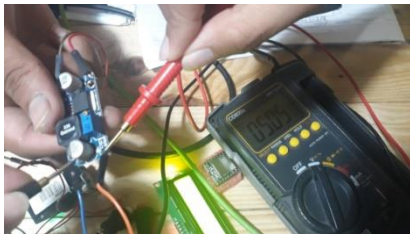
Gambar 5 Pengukuran Tegangan pada SIM800L
