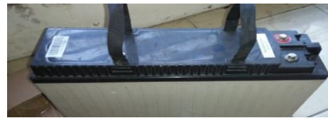
Gambar 7. Baterai 100 AH 12 Volt
