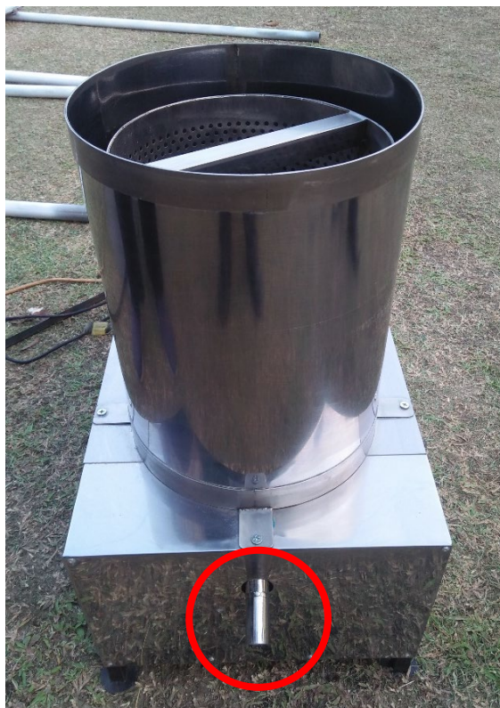
(b) Pipa saluran keluaran minyak.
