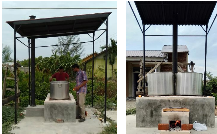
Gambar 5. Bentuk akhir tungku hemat energi sebagai hasil kegiatan Tim PKM USK yang dilengkapi dengan cerobong dan canopy (kegiatan ini dilakukan sebelum pandemi COVID-19)
