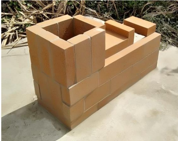
Gambar 3. Ruang pembakaran dengan bagian tempat udara panas naik ( heat-riser ) untuk menghasilkan aliran udara pada tungku hemat energi.
