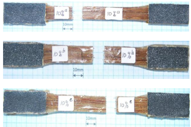
Gambar 9. Permukaan Patahan Komposit Tarik Fraksi Volume Serat 10%
