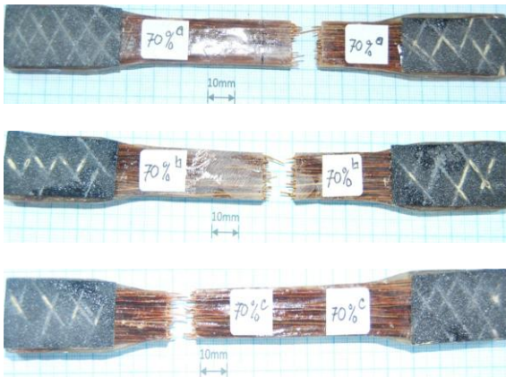
Gambar 11. Permukaan Patahan Komposit Tarik Fraksi Volume Serat 70%
