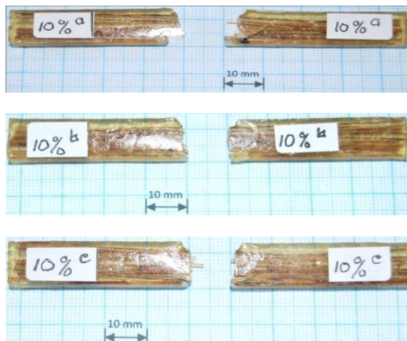
Gambar 15. Permukaan Patahan Komposit Impak Fraksi Volume Serat 10%
