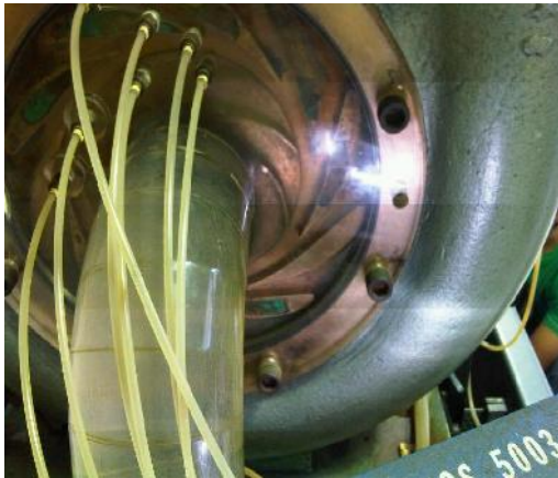
Gambar 9. Kondisi aliran melalui lorong sudu
