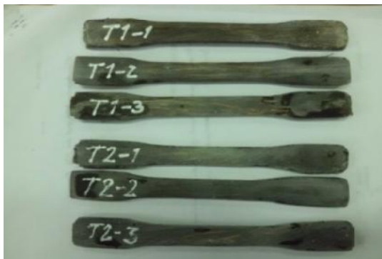
Gambar 8. Spesimen Uji Tarik
