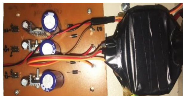
Gambar 10. Hasil realisasi rangkaian catu daya DC.
