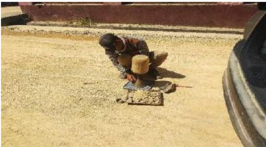
**Gambar 12.** Pekerjaan Uji *Sand Cone*
