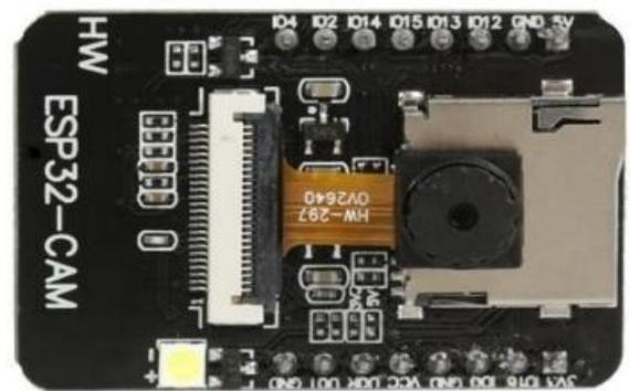
Gambar 3 ESP32-Cam dengan kamera OV2640
