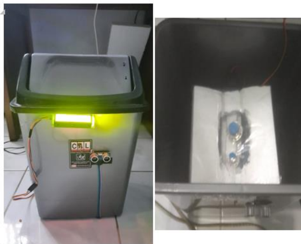
Gambar 8. Rancangan tempat sampah pemilah logam dan non logam
