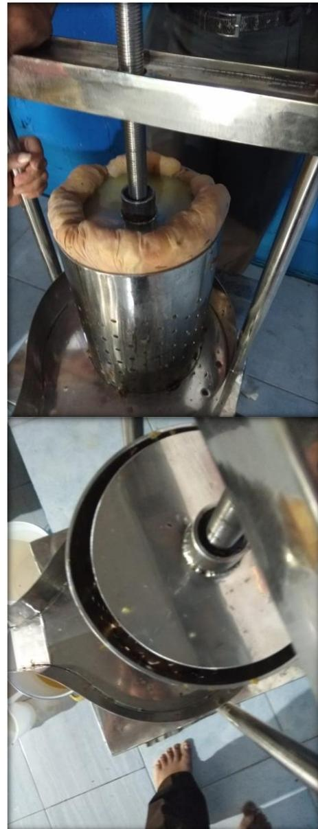
Gambar 11. Alat pemeras buah-buahan (*manual expeller press*)
