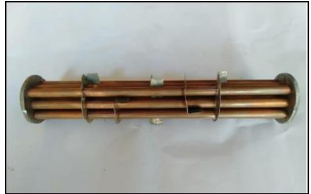
Gambar 5 Konfigurasi Fin Baffle pada STHE
