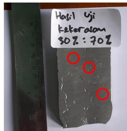
**Gambar 1.** Hasil identasi kekerasan pada spesimen B dengan perbandingan ADC 12
