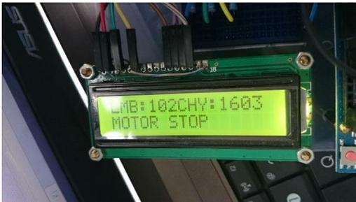
Gambar 4.7 Tampilan LCD Keypad Shield Pada Modul 1
