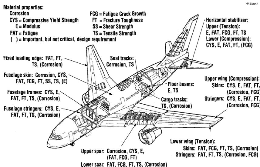
Gambar 1. Komponen-komponen pesawat terbang dan karakteristik material [1]
