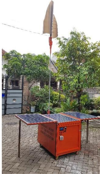
Gambar 6. Pembangkit Listrik *Portable* Tenaga Surya dan Angin Sistem *Hybrid* untuk Tempat Pengungsian Bencana Alam
