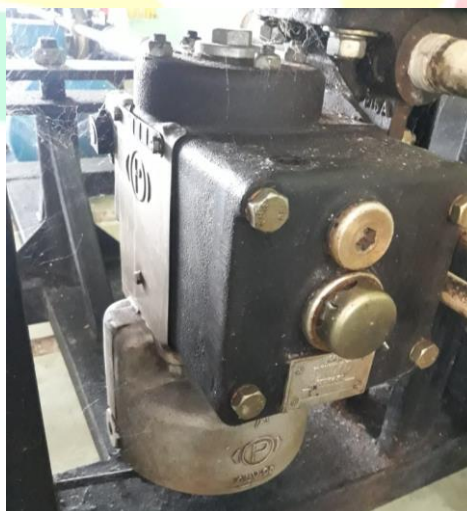
Gambar 7 Distributor valve Sumber : Dokumen Pribadi
