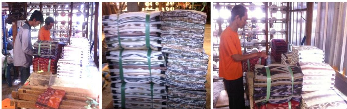
Gambar 8 Proses pengecekan mutu sarung sebelum di packing
