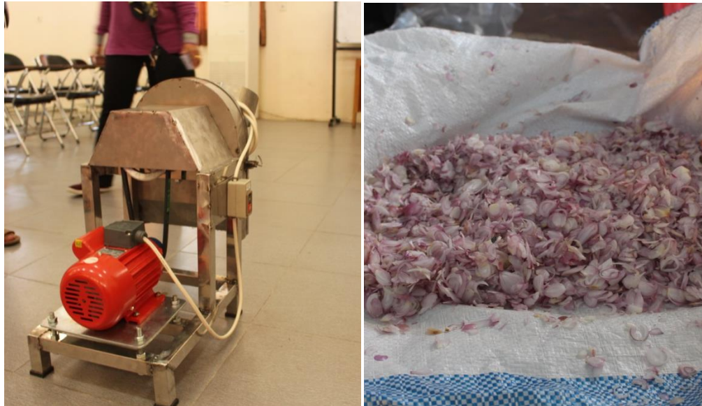
Gambar 5. Mesin setelah di rakit dan hasil rajangan bawang merah
