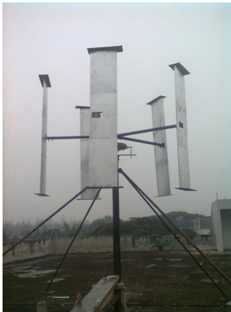
Gambar 3.1 Prototype Turbin angin tipe Darrieus H dengan profil sudu NACA 4415
