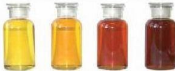
Gambar 1. Degradasi warna minyak transformator akibat kontaminan
