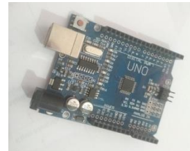
Gambar 6. Arduino Uno (Sumber: Hasil Dokumentasi Pribadi)
