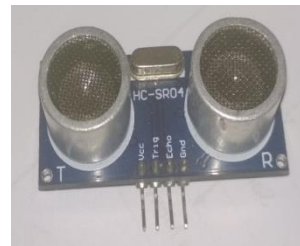
Gambar 3. Sensor Ultrasonik HC-SR04 (Sumber: Hasil Dokumentasi Pribadi)
