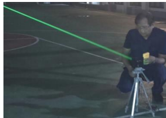
Gambar 5. Mengukur berkas penyebaran sinar laser dioda hijau.
