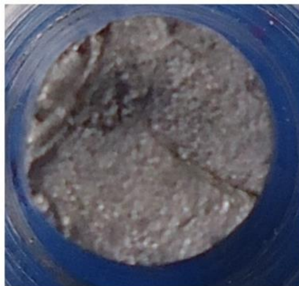
Gambar 10. Bentuk patahan AISI 316L secara macroscopic pada tegangan 462 MPa
