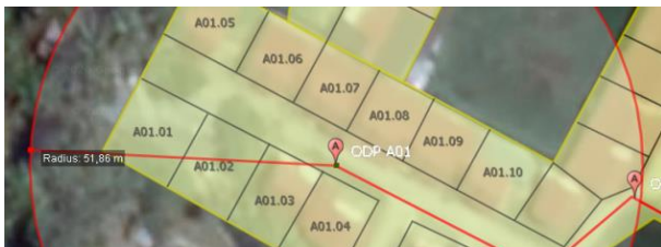
Gambar 7. Radius jangkauan kabel ODP-ONT
