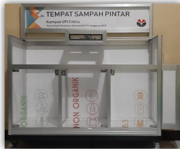
Gambar 5. Bentuk Prototipe Klasifikasi Tempat Sampah Otomatis
