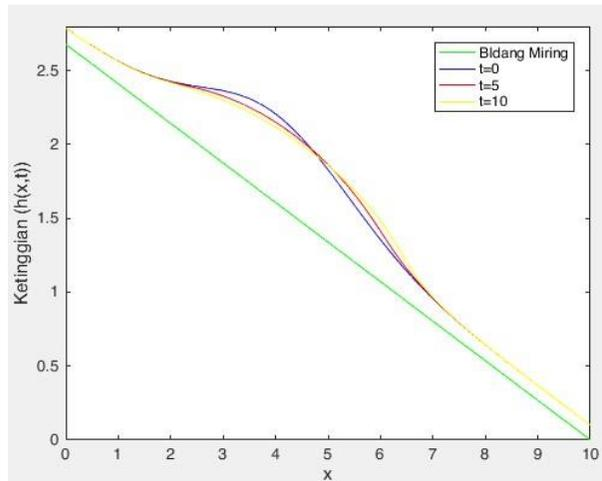
**Gambar 3.** Simulasi aliran fluida dengan nilai  $\lambda = 1$  dan  $\alpha=15$
