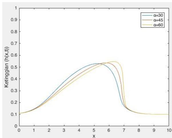
**Gambar 6.** Perbandingan kemiringan untuk fluida Newtonian pada  $t = 10$
