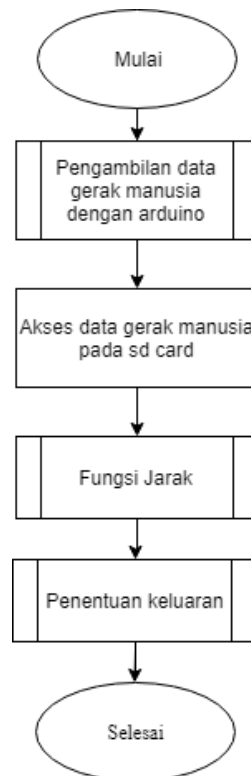
Gambar 4. Flowchart Keseluruhan Sistem Pengambilan Data Gerak Manusia
