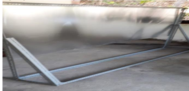
Gambar 5. Lembaran Alumunium sebagai repeater pasif
