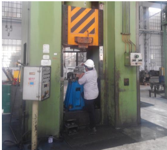
Gambar 7. Pengujian kekuatan struktur dies ironing
