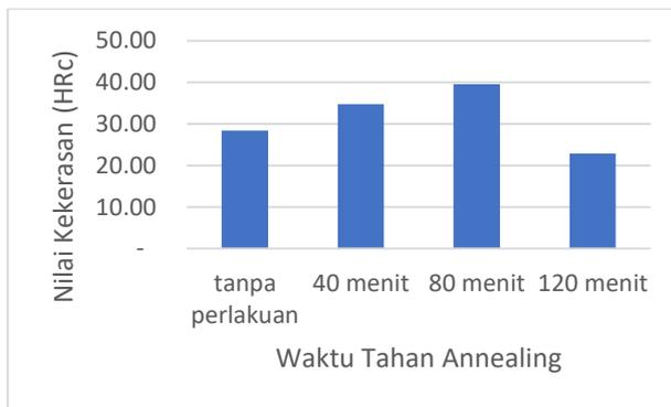
Gambar 4. Grafik nilai hasil pengujian kekerasan Rockwell C (HRC).
