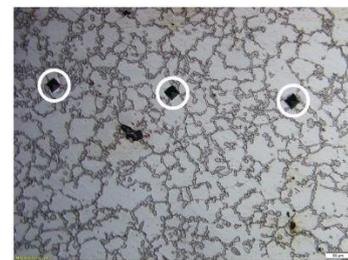
Gambar 3. Titik pengujian kekerasan dengan indenter.
