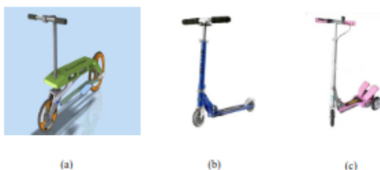
Gambar 15. Beberapa jenis skuter (a) Skuter 2 Pedal hasil rancangan (b) otoped, (c) skuter komersil
