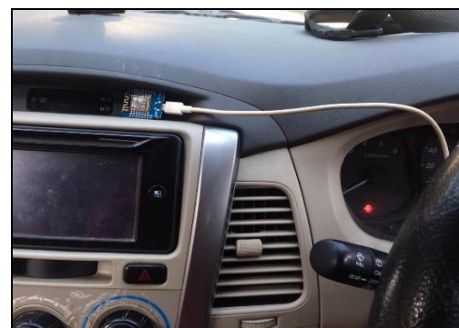
Gambar 8 Wemos sebagai client pada mobil
