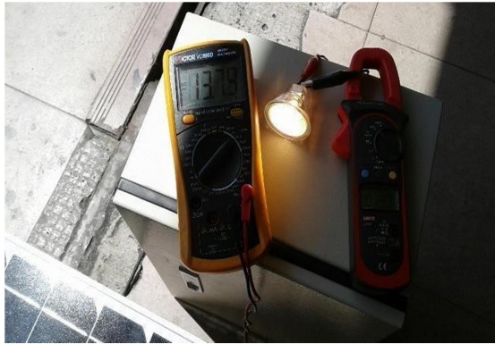
Gambar 16. Pengujian Panel Dengan Menggunakan Lampu Halogen 50 W
