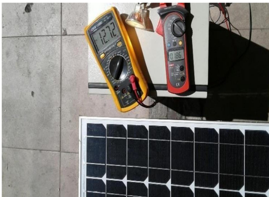
Gambar 16. Pengujian Panel Dengan Menggunakan Lampu Halogen 50 W
