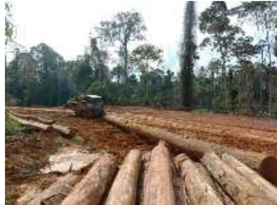
Gambar 1. Proses penyaradan dari blok tebang ke TPn
