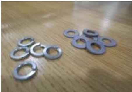
Gambar 3.7 HDG Washer dan Spring washer
