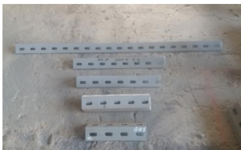
Gambar 3.7 berbagai variasi cutting profil hole anglebars
