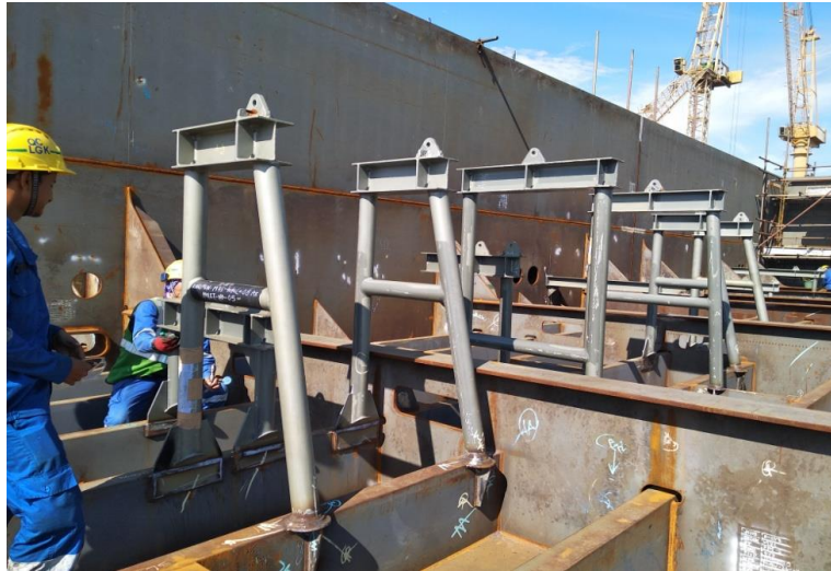
Gambar 3.5 Pemasangan Outfitting (Trolley Beam & Lifting Pad Eye) Pada Tahapan Kapal Saat Masih Proses Assembly
