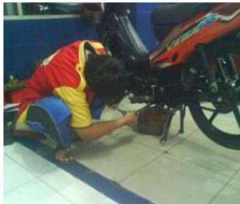
Gambar 3. Pengetapan Minyak Pelumas
