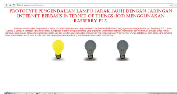
Gambar 7. Pengujian Led 1 Hidup
