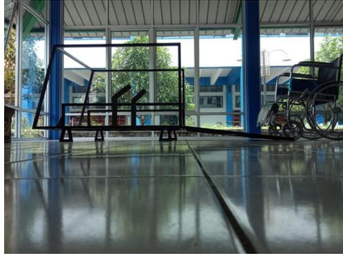
Gambar 4. Konstruksi *Jig* dan *Fixture* Kursi Roda
