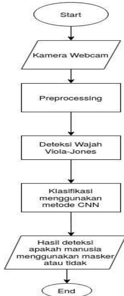
Gambar 3 Skema perancangan pengujian.
