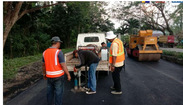
Gambar 6. Pengujian core drill AC-BC Sumber : Dokumentasi Lapangan, 2020
