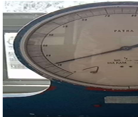
Gambar 6. Pembacaan Kuat Tekan Beton Umur 7 Hari Sumber : Hasil Pengujian Laboratorium, 2020
